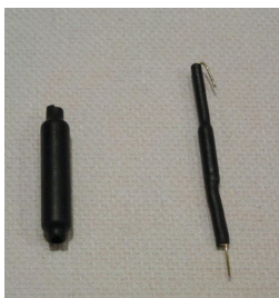
Magnet und Reed-Kontakt mit Schrumpfschlauch überzogen
